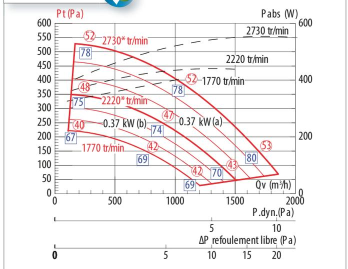
Les courbes sont établies avec l'ensemble moto-ventilateur en caisson, raccordé au refolement sur caisson réduit conforme à la norme ISO 5801.
